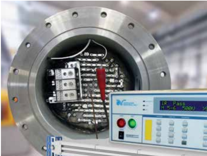
Megohm heater circuit precheck
